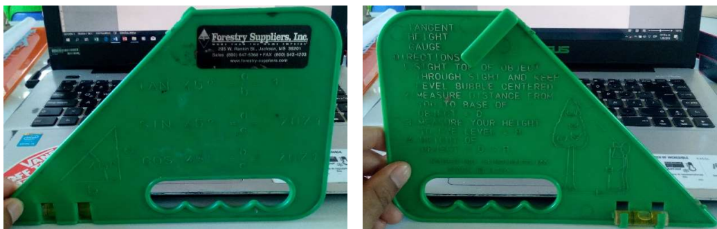
Ilustración 8. Equipo para medir alturas - Tangent height gauge. Fuente: Elaboración propia.
